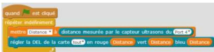
Ce programme renvoie et affiche la distance mesurée par le capteur US et les LEDs seront d'autant plus lumineuses que la distance mesurée est plus grande.
